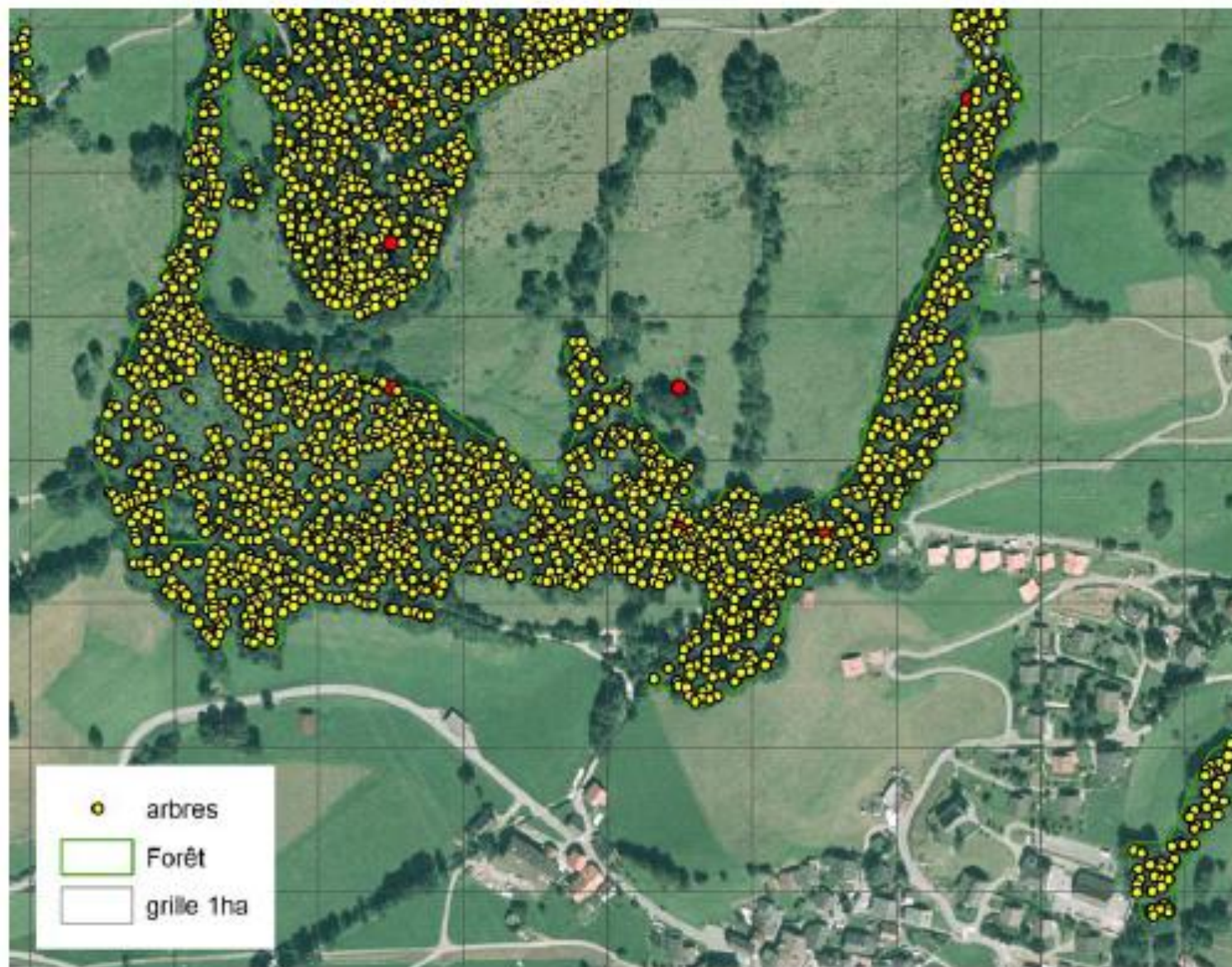
Fig. N° 2 : Arbres extraits des données LIDAR
